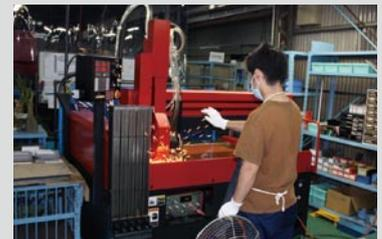
NCスタッド溶接機GUNMAN-1000 IIによる溶接作業。
