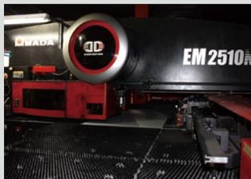
パンチングマシンEM-2510NT+ASR-48Mによるパンチング加工。
